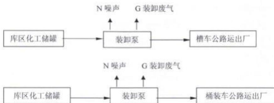
图 3.2-1 液体化工品装车工艺流程及产污环节
