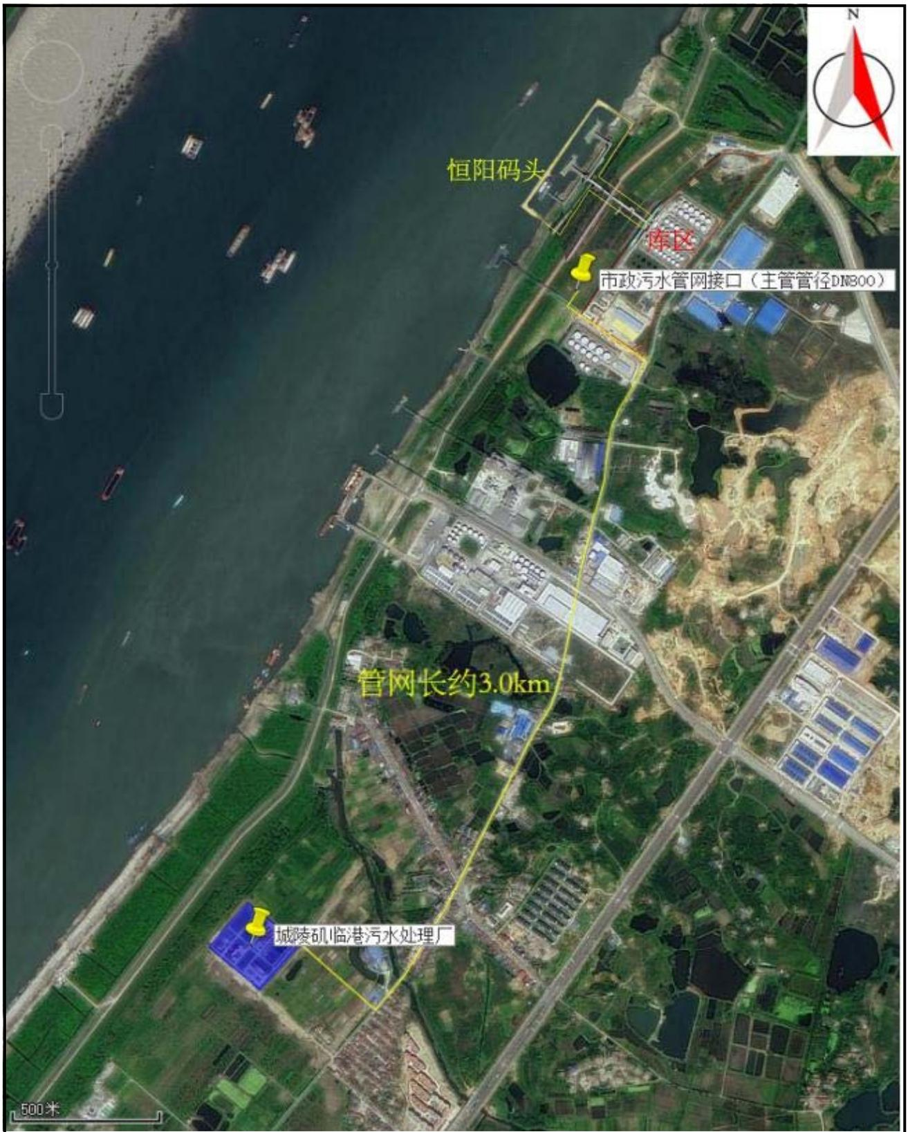
附图9 本项目纳污排水管网示意图
