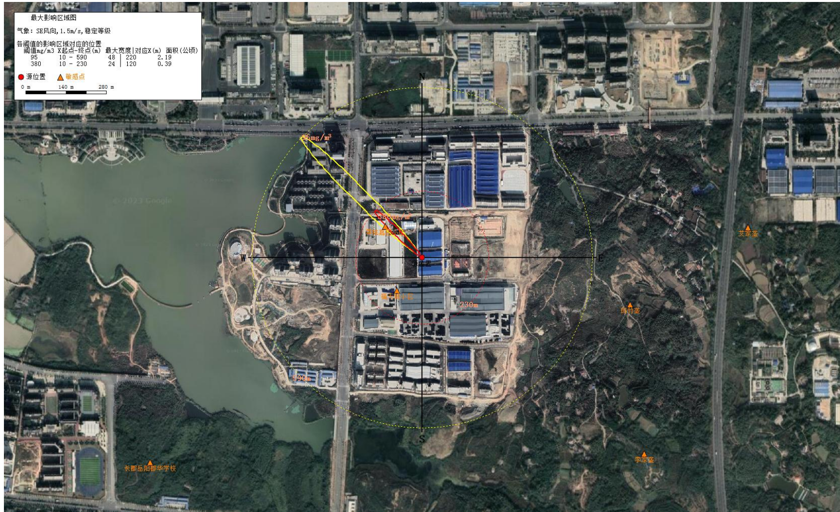
图 5.1 最不利气象条件下 CO 预测浓度达到不同毒性终点浓度的最大影响范围分布图
