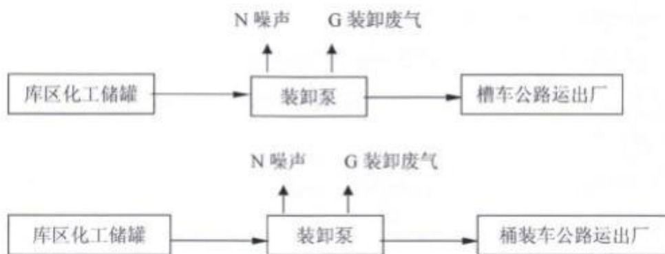
图 2-3 液体化工品装车工艺流程及产污环节
